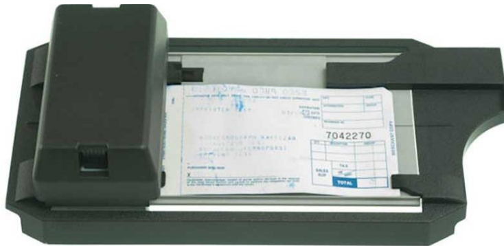
Slika 2 – Otiskivanje podataka izbočenih na bankovnoj kartici uređajem za otiskivanje (eng. imprinter ). ( izvor )
