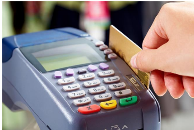
Slika 3 – Očitavanje podataka s magnetske trake bankovne kartice POS uređajem. ( izvor )
