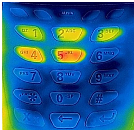
Slika 8 – POS uređaj snimljen infracrvenom kamerom nakon utipkavanja broja „12345“
