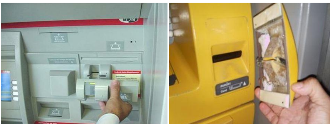
Slika 6 – Primjeri skriveno ugrađenih skimmer uređaja ( izvor )
