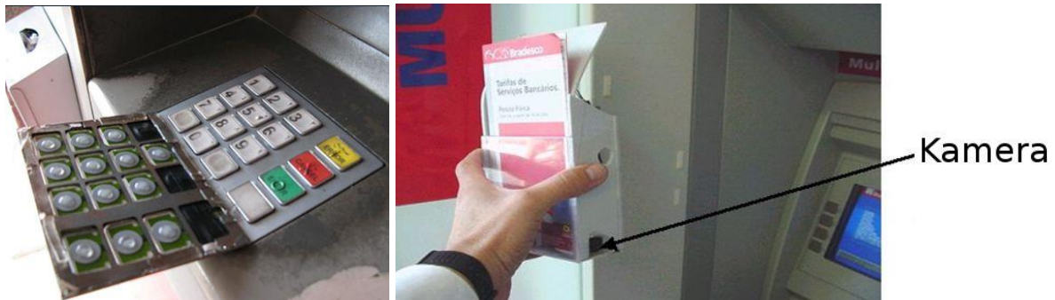
Slika 7 – Primjeri uređaja za skriveno prikupljanje PIN-ova – lažna tipkovnica (lijevo) i skrivena kamera (desno) ( izvor )
