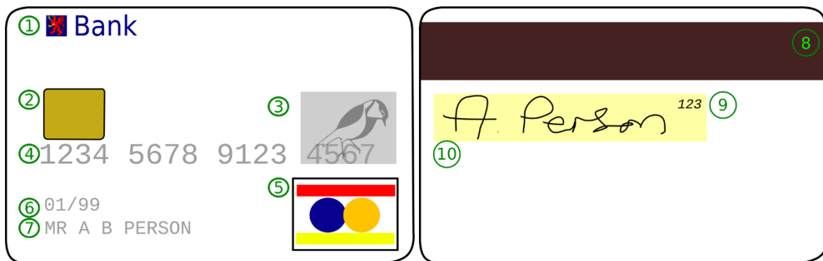
Slika 1 - Primjer prednje (lijevo) i stražnje (desno) strane moderne bankovne kartice s označenim dijelovima.
