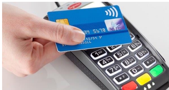
Slika 5 – Beskontaktna komunikacija POS uređaja i čipa na bankovnoj kartici. ( izvor )
