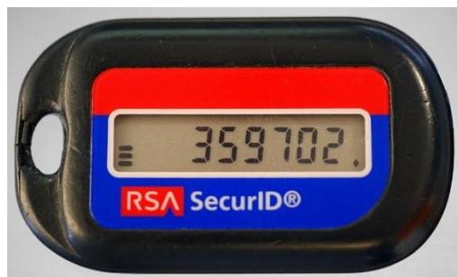
Slika 12 – sigurnosni token za generiranje jednokratne lozinke u obliku samostalnog uređaja; na zaslonu je prikazana trenutna jednokratna lozinka ([izvor](#))
