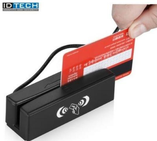
Slika 3 – primjer kartice s magnetskom trakom te odgovarajućeg čitača ([izvor](#))
