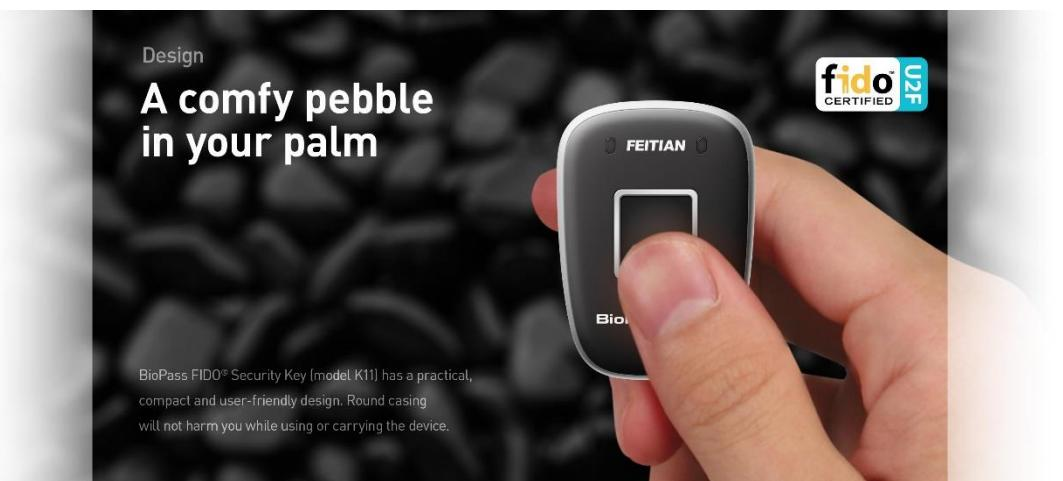
Slika 28 – uređaj kompatibilan s U2F standardom koji ujedno ima i čitač otiska prsta ([izvor](#))
