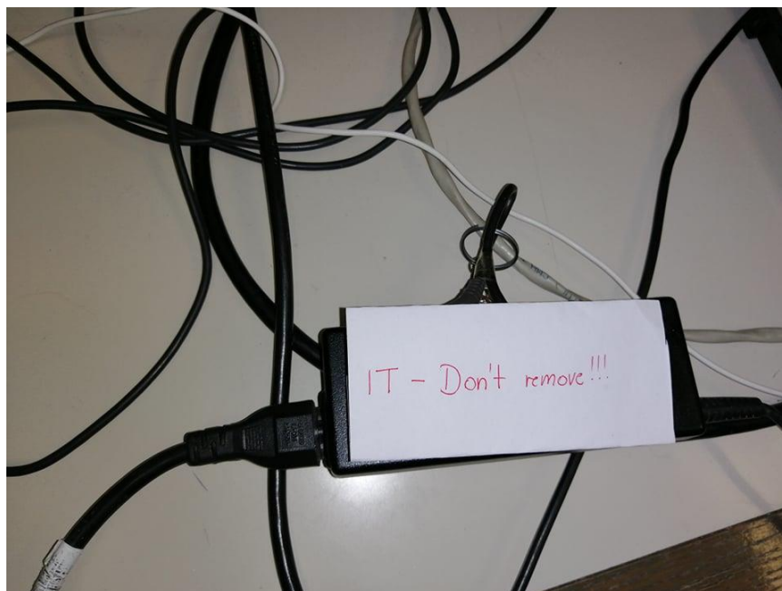
Slika 17 Natpis „IT-Don't remove“ na zlonamjernom uređaju
