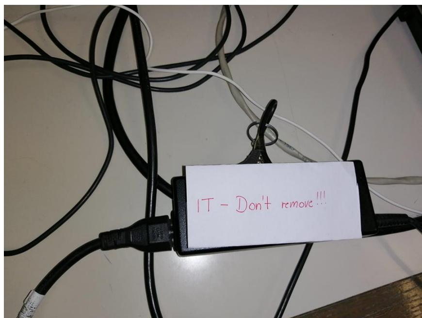
**Slika 17 Natpis „IT-Don't remove“ na zlonamjernom uređaju**
