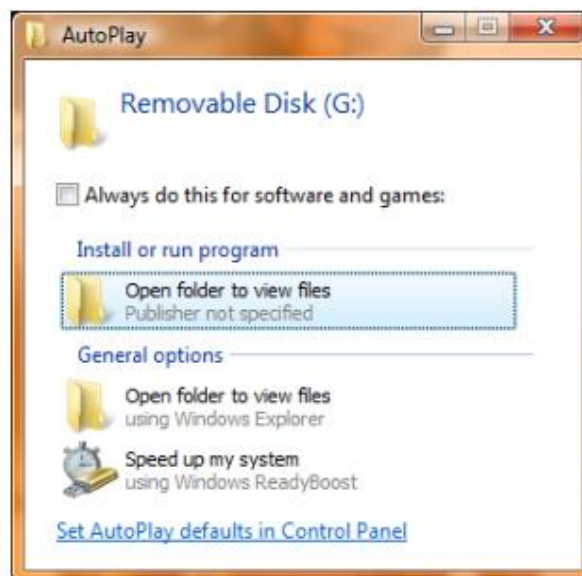
Slika 4 Primjer tehnike obmane kojom USB stick može zaraziti računalo (6)
