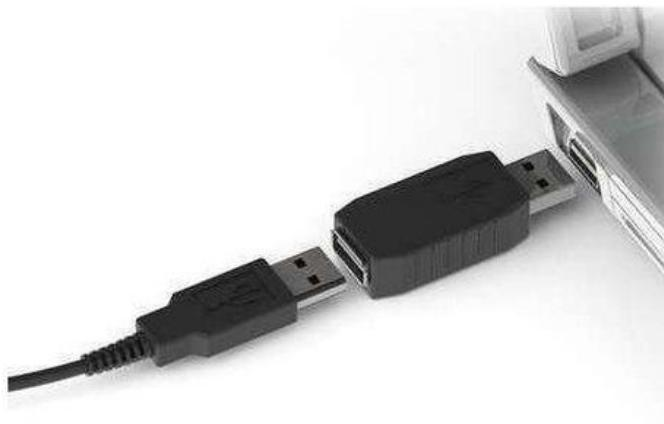
Slika 14 Priključivanje tipkovnice u hardverski keylogger koji se priključuje na računalo (15)
